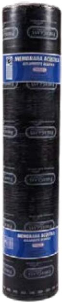
Lámina fabricada con base en asfalto modificado con polímeros, copolímeros y elastómeros, tratado con aceite plastificante y llenantes minerales, reforzada con armadura central en fibra de vidrio con características de resistencia a impactos sonoros y de aislamiento acústico.
