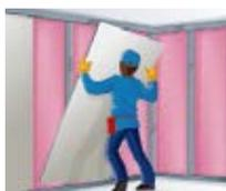
8.- Es importante que el material se expanda completamente para obtener el aislamiento apropiado. La barrera de vapor, en caso de ser necesario, debe ir hacia el área más cálida en invierno.
