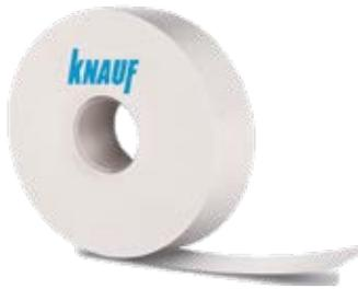
Cinta de papel con un centro pre marcado y micro perforaciones que permiten eliminar el exceso de aire para evitar sopladuras.
